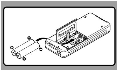
Insérez les piles dans la direction inscrite à l'intérieur du compartiment des piles de l'enregistreur. De plus, lorsque vous insérez les piles, placez-les de façon à ce que le ruban soit situé sous les piles, comme le montre l'illustration ci-dessous. Les piles peuvent ensuite être retirées facilement en tirant sur le ruban. **Lorsque vous tirez sur le ruban, il se peut que les piles sautent du compartiment, veillez donc à appuyer légèrement sur les piles avec votre doigt quand vous tirez.**
