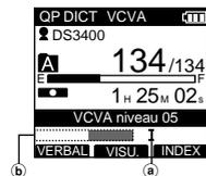
**a** Niveau de démarrage (se déplace vers la gauche ou vers la droite en fonction du niveau spécifié)
