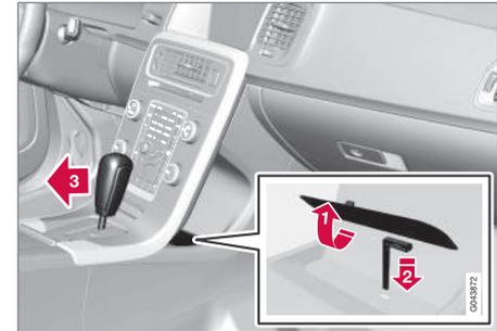
Si la voiture ne peut être conduite, par ex. lorsque la batterie est déchargée, il faudra sortir le sélecteur de vitesses de la position **P** pour pouvoir déplacer la voiture.
