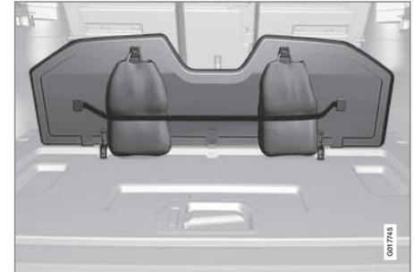
Dispositif de retenue pour sacs à provisions sous la trappe rabattable du plancher.
