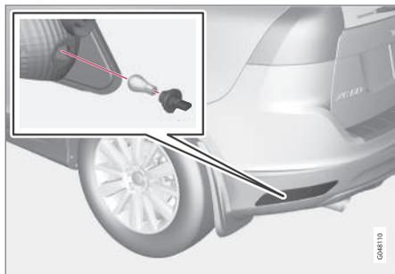
L'ampoule du feu antibrouillard arrière est accessible derrière le pare-chocs.
