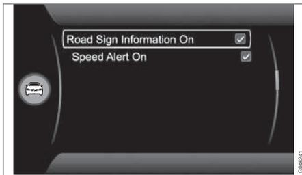
L'affichage des panneaux de limitation de vitesse sur le combiné d'instruments peut être désactivé. La fonction peut être activée/désactivée dans le système de menu **MY CAR**. Pour une description du système de menu, voir MY CAR (p. 120).
