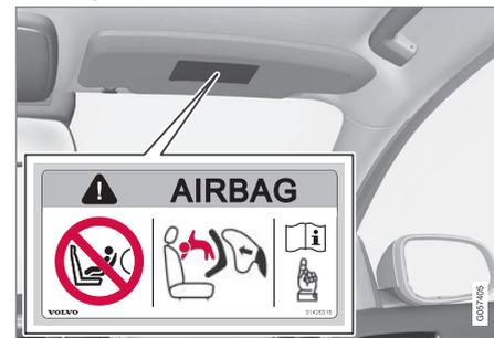
Autocollant sur le pare-soleil du côté passager.
