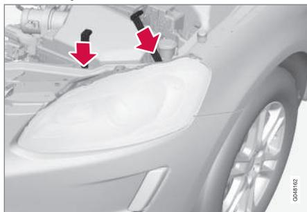
Lors de la pose, passez la main pour vérifier si la goupille d'arrêt longue est bien fixée dans les deux œillets.
