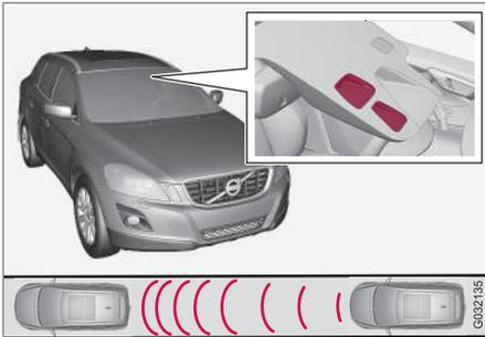
Fenêtre d'émission et de réception du capteur laser<sup>12</sup>.
