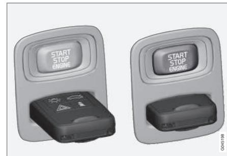
Contacteur d'allumage avec télécommande retirée/insérée.
