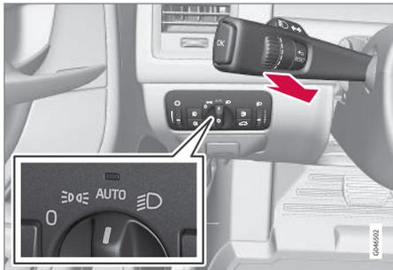
Levier au volant et commutateur d'éclairage en position **AUTO**.
