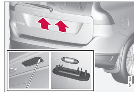
1. Desserrez les vis avec un tournevis.
