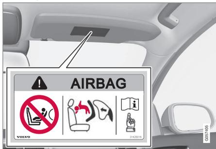
Autocollant sur le pare-soleil du côté passager.
