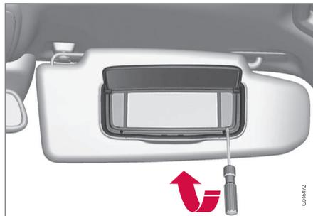
1. Insérez un tournevis sous la lentille et faites lever avec précaution sur les pattes, sur le bord.
