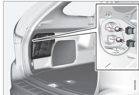
Les ampoules des feux stop et de recul sont remplacées depuis l'intérieur du compartiment à bagages.
