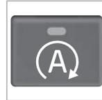
La fonction Start/Stop est automatiquement activée lors du démarrage du moteur. Le conducteur en est informé par l'apparition du symbole de la fonction sur le combiné d'instruments et l'activation du témoin du bouton Marche/Arrêt.
