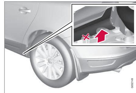
Vérifiez que le cric se trouve dans la fixation comme indiqué sur l'illustration et que le pied est placé à la verticale de la fixation.
