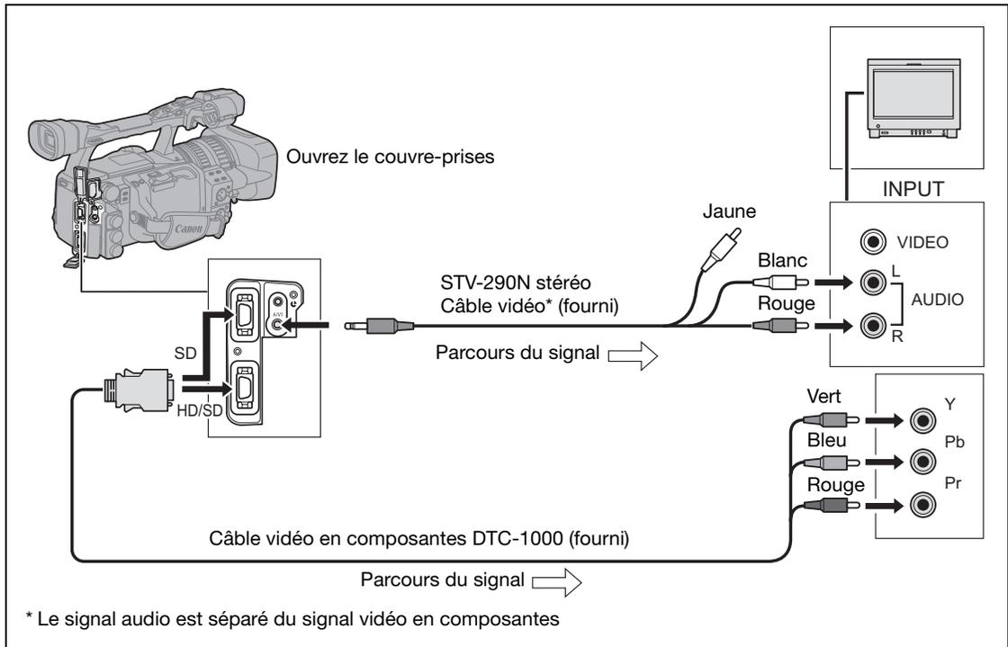
Lors de l'utilisation de la prise HD/SD COMPONENT OUT, sélectionnez le signal vidéo en composantes approprié en fonction du téléviseur ou du moniteur connecté.
