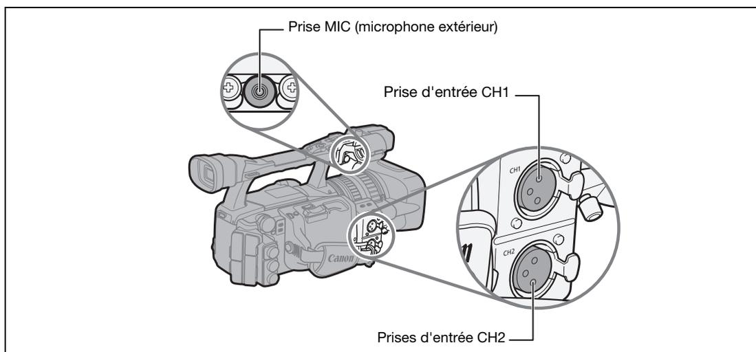
Quand vous connectez un microphone extérieur à la prise MIC, le microphone intégré est mis automatiquement hors service. Si nécessaire, vous pouvez utiliser le support du microphone.
