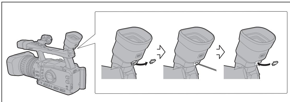
1. Ouvrez le cache de protection (par ex. en utilisant un tournevis à tête plate).
