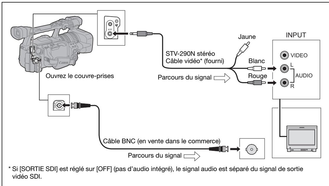
Mettez en service la sortie HD/SD SDI et sélectionnez l'option de sortie vidéo appropriée (HD ou SD).
