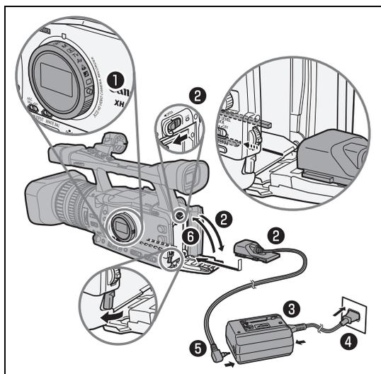
Ouvrez le couvercle du logement de la batterie, poussez le verrou BATT.RELEASE vers la gauche et retirez le coupleur DC.
