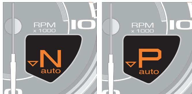
Si le système électrique le permet, contrôler en tournant la clé de contact sur la position **II**, si sur l'écran de la boîte de vitesses s'affiche la lettre « N ». Sur l'écran TFT gauche le message suivant s'affichera : « Vitesse n'est pas en P position ». Au même moment on entendra quatre fois de suite un signal sonore pour avertir que le déblocage s'est bien produit.
