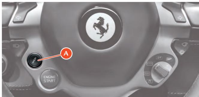
Si on a appuyé sur la touche **A** et ensuite le conducteur change la position du « Manettino », le réglage des suspensions suit la logique de fonctionnement dictée par le « Manettino ».
