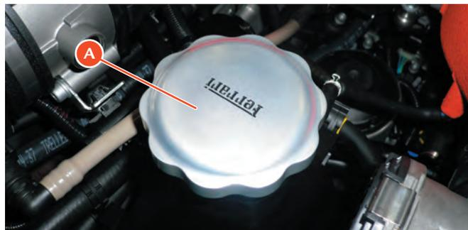
Après la remise à niveau le témoin « niveau huile insuffisant » affiché sur l'écran TFT gauche peut rester allumé pendant longtemps. Cela permet au système d'effectuer tous les contrôles nécessaires. Il s'agit d'un comportement tout à fait normal.
