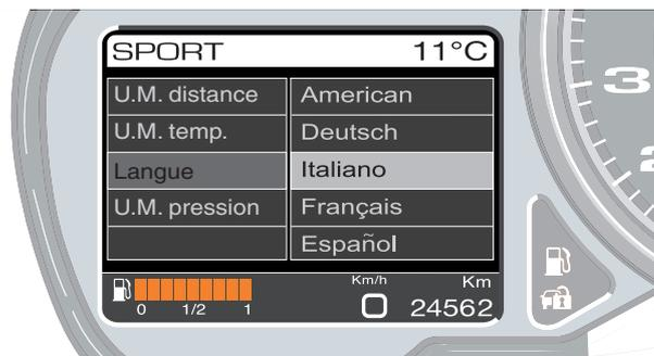
Après avoir sélectionné la fonction, chaque sous-fonction ou les paramètres pouvant être activés sont affichés. Pour sélectionner on utilise toujours les touches UP et DOWN, alors qu'une pression de courte durée sur la touche OK (ou bien RIGHT) active une sous-section éventuelle, ou bien active le paramètre sélectionné.
