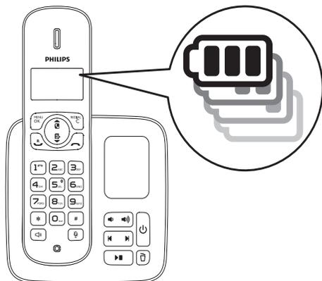
L'icône de batteries indique le niveau actuel de charge des batteries.
